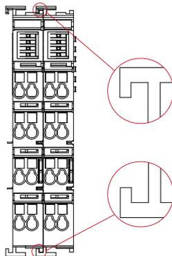
② 将I/O模块沿着箭头方向推入DIN卡销，将I/O模块固定在DIN导轨上。
